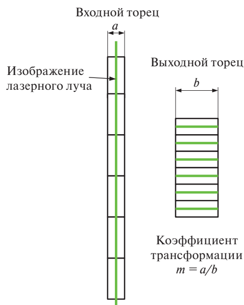
Рис. 2. Трансформация оптоволоконного коллектора.
